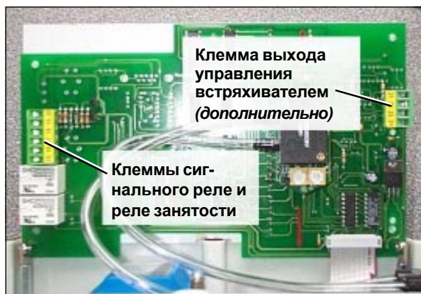
Рис. 8. Подключение сигнального реле, реле занятости и выхода управления встряхивателем
